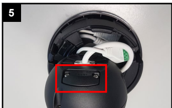
Reset: Reset-Taste fünf Sekunden lang gedrückt halten, wenn Sie auf ihre Werkseinstellungen zurücksetzen möchten.
