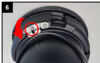
Kamera wieder einsetzen, die Blickrichtung ausrichten, den Bügel wieder einklappen und die Schraube festziehen.
