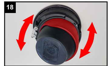
Sie können nun die Kamera drehen, um die Blickrichtung auszurichten...
