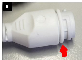
O-Ring auf Netzwerkbuchse am Kabel der Kamera setzen.
