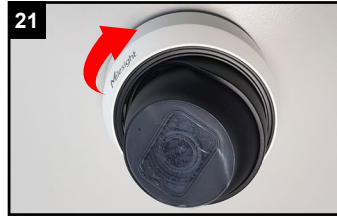
Weißer Haube wieder aufsetzen und einrasten lassen.
