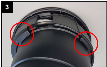
Die Kamera wird auf der anderen Seite von zwei Bügel festgehalten. Drücken Sie diese vorsichtig aus den Bügeln heraus
