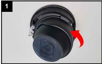
Der Kartenslot und die Reset-Taste befinden sich hinter der Abdeckung auf der Rückseite des Kamera-Kugelkopfs.
