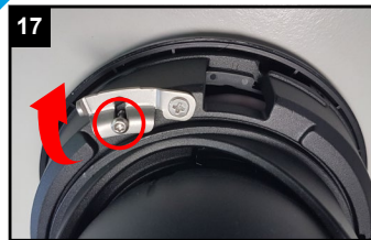
Kamera festhalten, damit sie nicht herunterfällt und dabei Bügel ausklappen.
