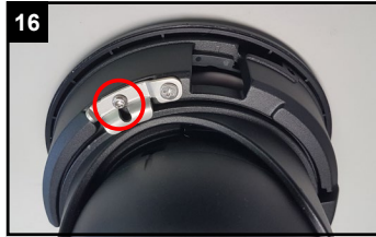
Um die Blickrichtung einzustellen, Schraube soweit lockern, bis man den Bügel ausklappen kann.
