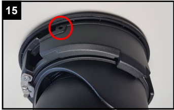
Schraube wieder festziehen. Überprüfen Sie den festen Halt der Kamera.
