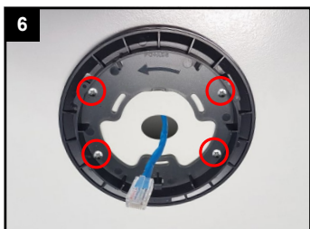
Verwenden Sie die mitgelieferten Dübel und Schrauben zur Montage.
