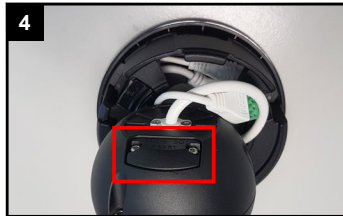
Kamera festhalten, damit sie nicht herunterfällt. Unter der Abdeckung befinden sich der Kartenslot und die Reset-Taste.
