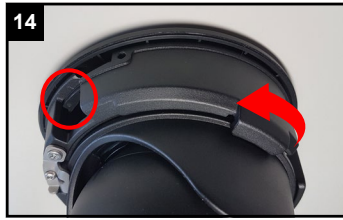
Kamera in Pfeilrichtung drehen, bis sie wieder in die Bodenplatte einrastet.
