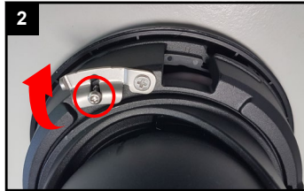
Kamera festhalten, damit sie nicht herunterfällt, Schraube lösen und Bügel ausklappen.
